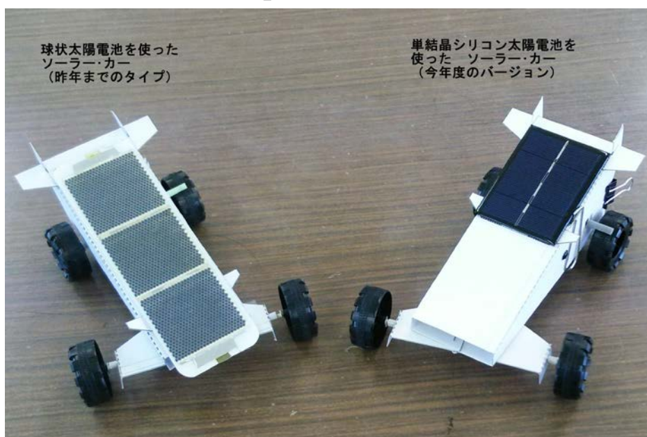
作成したソーラーカー（第1回「電気を『作る』 発電実験とソーラー・カーの製作」）
