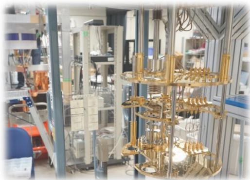
図4 希釈冷凍機が設置されている部屋の写真。右側に冷凍機内部、左側に測定系の電子機器ラック。
