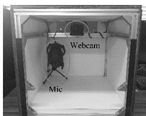
図5 ウェブカメラとコンデンサマイクを設置した測定環境
