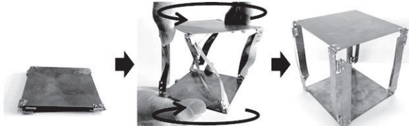
図 2 作成した立方体展開構造物の模型
