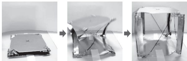
図 7 自律展開機構による展開の様子
