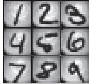
図7 SPI システムで取得した再構成画像
