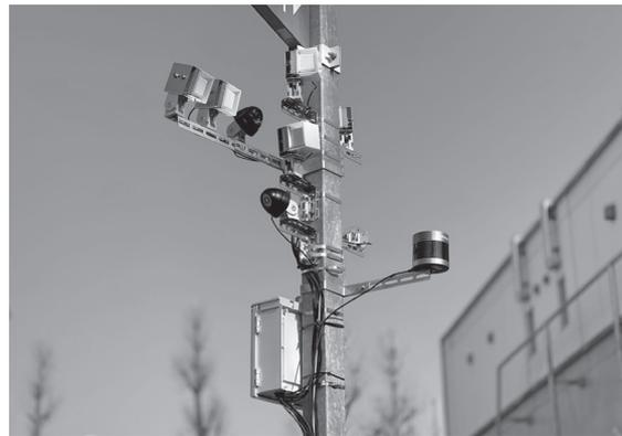
図16 60GHz帯ミリ波無線伝送システム
