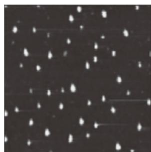
図5. NP(Th/TPE)薄膜のAFMトポグラフィー像( $3 \times 3 \mu\text{m}$ )。
