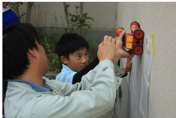
(b) 小学校外壁の鉄筋探査体験
