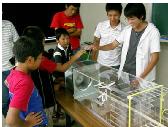
簡易風洞による揚力実験
