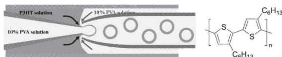
図 3 マイクロ流体デバイスを用いる EC ポリマーマイクロカプセルの作製法とポリ(3-ヘキシルチオフェン-2,5-ジイル)の分子構造
