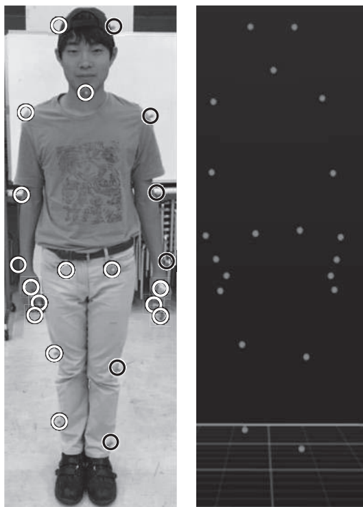
(a) マーカ取り付け箇所 (b) マーカ認識結果 図2 倒立振り型ヒトのバランス運動測定装置
